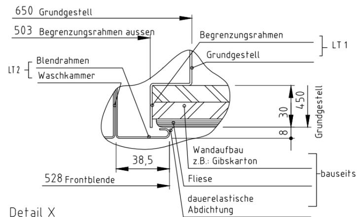
Montage des Grundgestell auf den baus. Estrich. WC-Keramikhöhe: 400mm +/- 10mm ( gültig für alle Wand WC's nach DIN EN 38 mit einem Schraubenabstand von 180 mm ). Bei Montage auf dem Rohfußboden oder einer anderen Keramikhöhe kann ein zusätzlicher Ausgleichsrahmen mitgeliefert werden. (siehe Detail Z).
